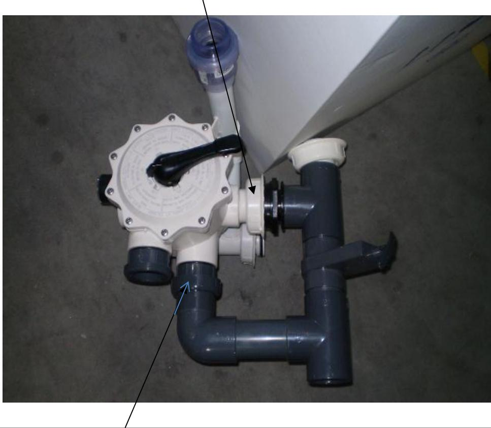
**Danach befestigen Sie die 3/3 Kupplung über dem Gewinde und drehen diese auch fest
